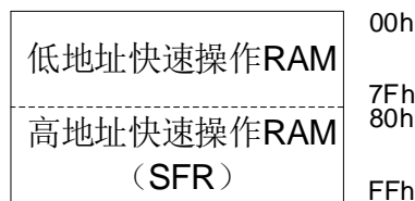
SRAM 数据存储器映射图
